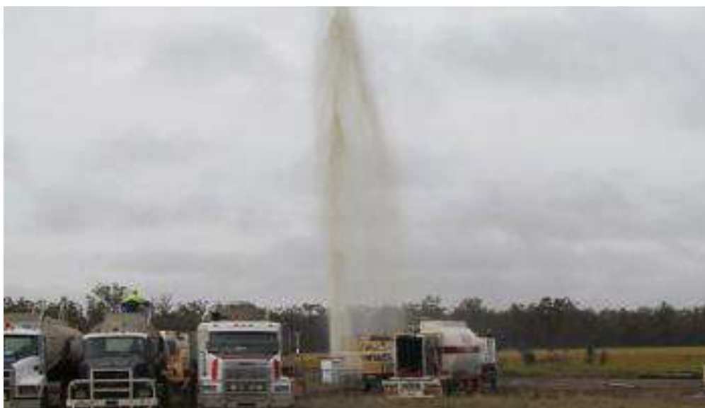
Figura 15 – Evento de blowout, com projeção de fluidos, em um poço de gás
