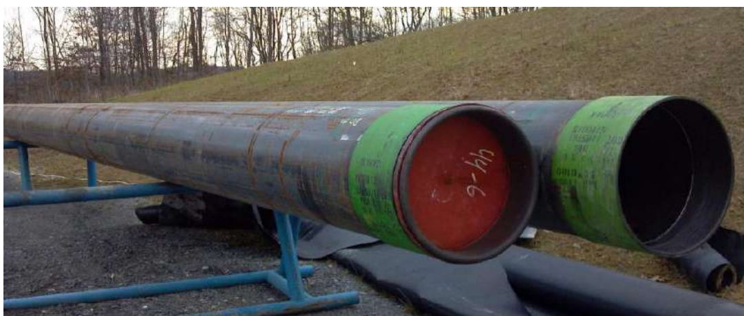
Figura 6 – Segmentos de tubulação de aço utilizados no revestimento de poço.
